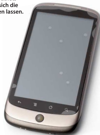
An den fünf kleineren Flecken hat sich beim Aufziehen der Folie Staub abgesetzt. Die hochgewölbten Kanten zeigen, dass die Folie etwas zu groß bemessen war.
