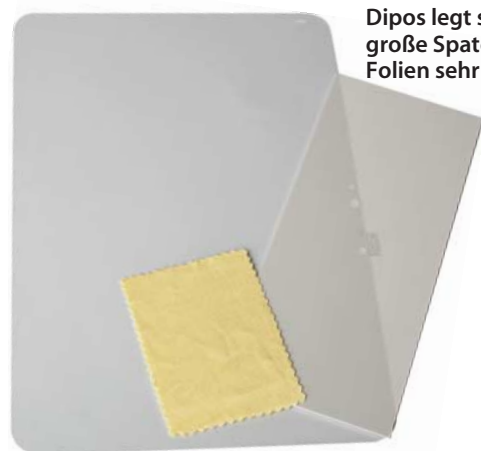
An den fünf kleineren Flecken hat sich beim Aufziehen der Folie Staub abgesetzt. Die hochgewölbten Kanten zeigen, dass die Folie etwas zu groß bemessen war.
