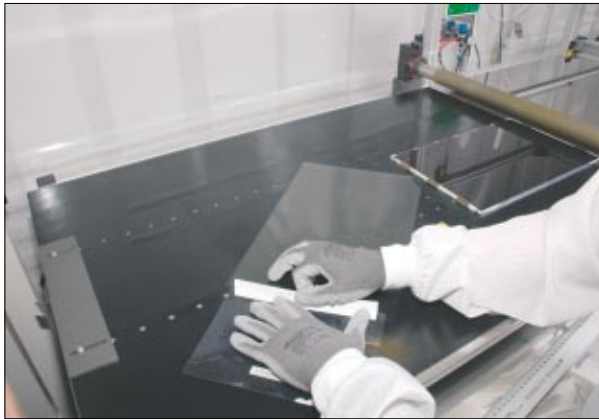
Eine spezielle Folie von 3M hilft beim Entspiegeln von Displays, doch beim Aufbringen ist Präzision gefragt
