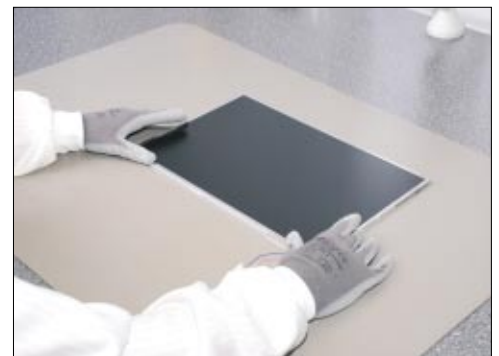
Das entspiegelte Display nach dem Zusammenbauen wartet auf den Wiedereinbau ins Notebook
